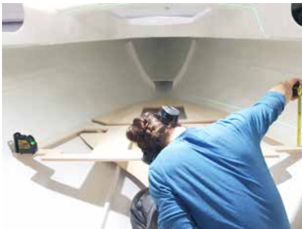
Het productieproces: het interieur wordt gespoten, de nieuwe delen worden ingemeten, plaatsing van het raamspantconstructie. Rechts: versterking van de mastbalk met een U-vormig zadel.
