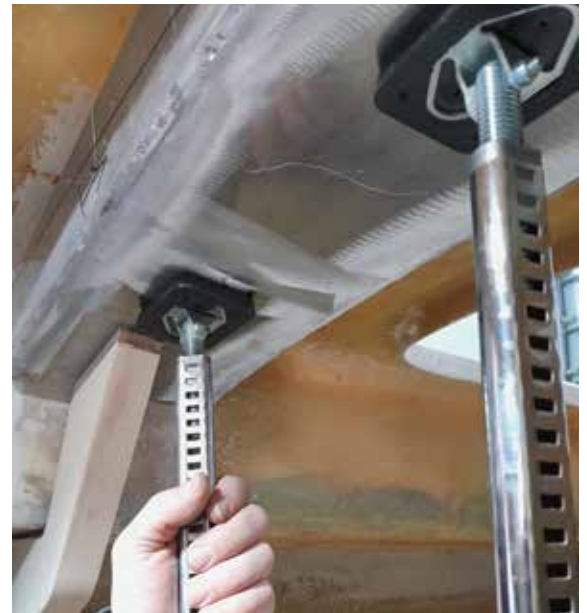
Het productieproces: het interieur wordt gespoten, de nieuwe delen worden ingemeten, plaatsing van het raamspantconstructie. Rechts: versterking van de mastbalk met een U-vormig zadel.
